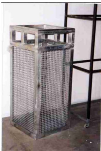
Cesta in ferro per il posizionamento delle patate nel preventivo trattamento anticrittogamico
