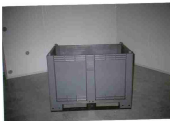
Vasca pallettizzabile con spurgo inferiore per il posizionamento della cesta in ferro durante il trattamento anticrittogamico
